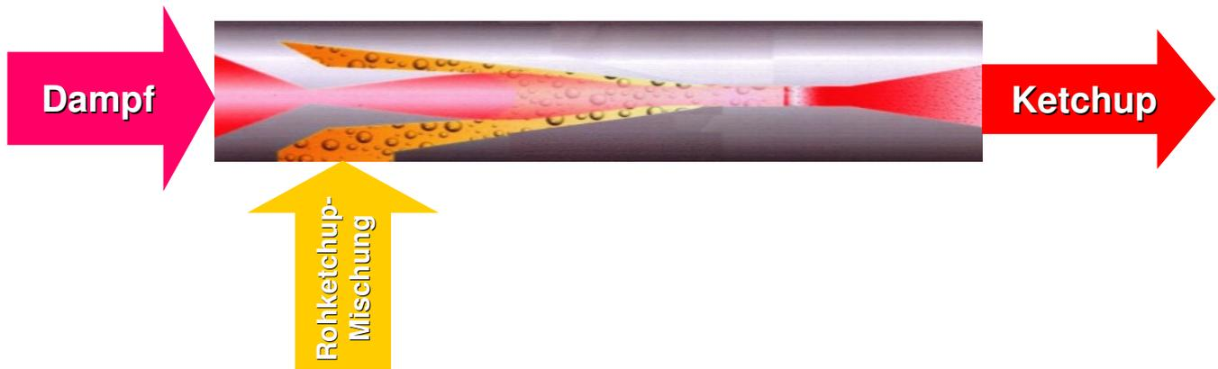
Das Herzstück des Ketchup In-line Kochers ist der patentierte "MAKLAD-Injektor". Mit ihm wird in einem einzigen Schritt die Rohketchupmischung mittels Direktdampfinjektion – der sogenannten "MAKLAD-Überschall-Verdichtungsstoß-Technologie" – pasteurisiert und homogenisiert.
